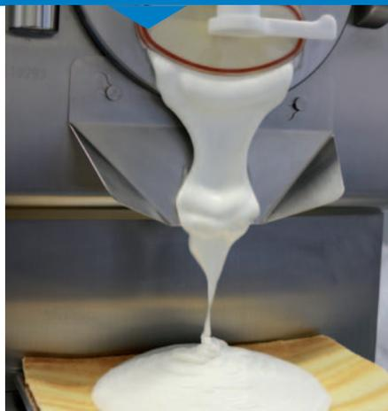
Dank des **Abstandhalters**, der jederzeit montiert werden kann, ist es möglich die Eisauflassungöffnung zu verkleinern, um die Entnahme des Crystal-Produkts zu erleichtern.
