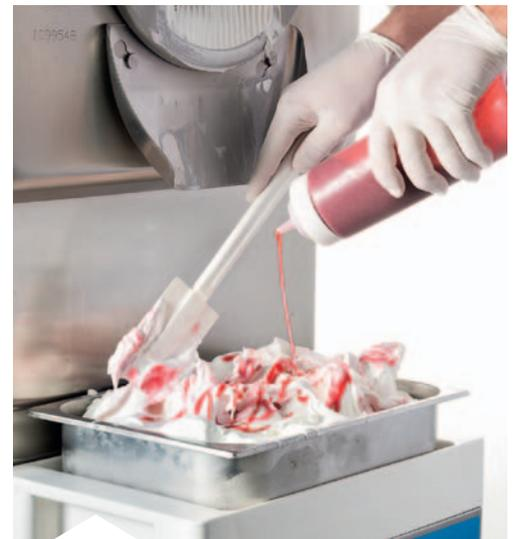
Für eine bessere Streifenfärbung des Gelato in der Schale, kann die Rührwerkgeschwindigkeit reduziert werden, indem man die Ausgabe vollkommen zum Stoppen bringt und damit die Verteilung des Toppings erleichtert. Durch erneutes Steigern der Rührgeschwindigkeit, beginnt die Ausgabe erneut.
