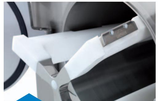
Rührwerk aus POM, unempfindlich gegen Kälte und Wärme, für die **vollständige Ausgabe von Eis und Cremes**. Selbstregulierende, herausnehmbare Abstreifer für eine komplette Reinigung und Leerung des Zylinders.
